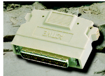
Terminator: aktiv: 2,85 V passiv: ca 3V
